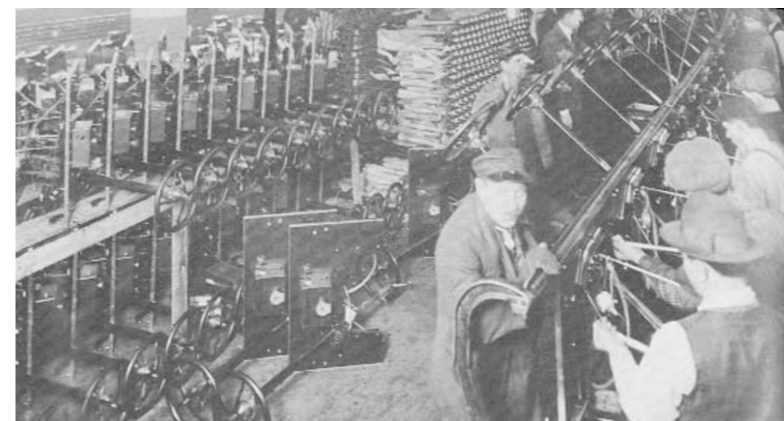
Figura 1. Sección de cadena de montaje. Trabajadores instalando volantes.
